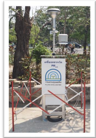
เครื่องตรวจวัดฝุ่นละออง ขนาดเล็กสำหรับตรวจวัด ภายนอกอาคาร
